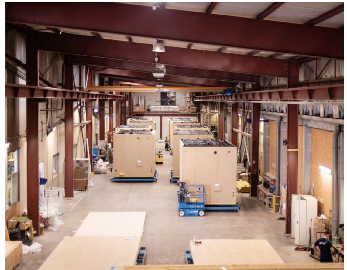
Ce mode de fabrication en usine intègre dans un process industriel tous les métiers du bâtiment, tels que les charpentiers, les plombiers, les électriciens ou encore les peintres et permet de livrer 2 fois plus vite et de poser sur le chantier jusqu'à 10 modules par jour.
